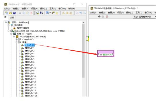
然后下拉模块图标下方的蓝色点,得到全部16个DI通道和16个DO通道的数据接口,如下图:
