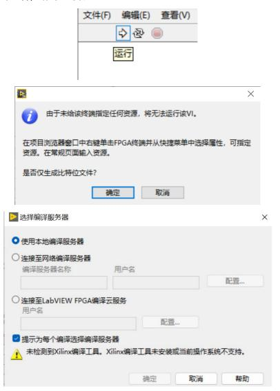
编译好之后,在项目文件夹下会发现刚刚生成好的放置比特文件的文件夹: (编译好之后产生的错误 1003弹窗不必在意,由于FPGA程序无法直接运行导致,请忽略)
