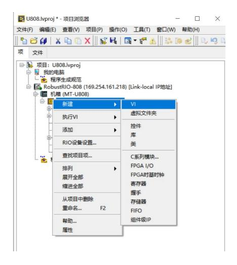
在后面的编程中,我们可以将模块的DI和DO接口拖到FPGA VI程序框图中,用于采集数据,右键将DO 接口转化为写入,如下图:
