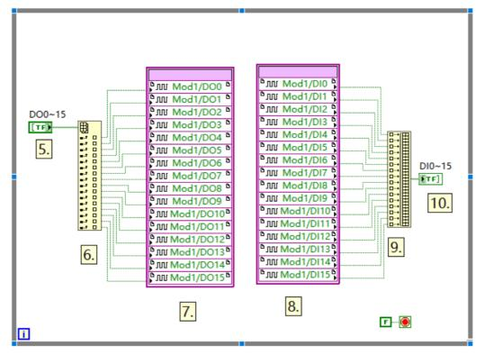
上位机/1程序框图(两种写法):
