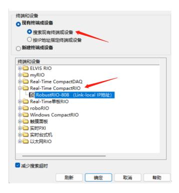
此时RobustRIO通过网线与上位机PC直连(IP地址在同一网段),所以可以直接发现设备,点击确定 然后在这里可以看到刚刚新建好的RT终端。
