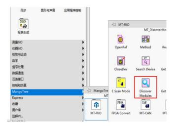
具体步骤是:在RT终端路径下新建一个VI并保存,然后将Discover Modules函数放置,然后点击左上角运行按钮,就可以在前面板得到所有插槽的板卡型号信息,如下图:
