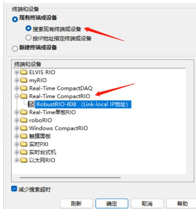
此时RobustRIO通过网线上位机PC直连（IP地址在同一网段），所以可以直接发现设备，点击确定然后在这里可以看到刚刚新建好的RT终端。
