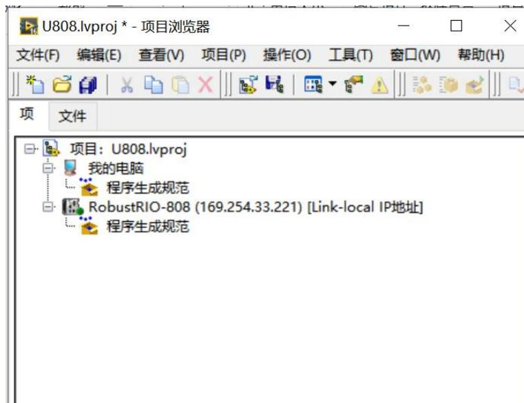
右键RT终端选择连接，连接好之后主机图标上方的指示灯为亮绿色，然后在RT终端下新建MT-U808机箱终端：
